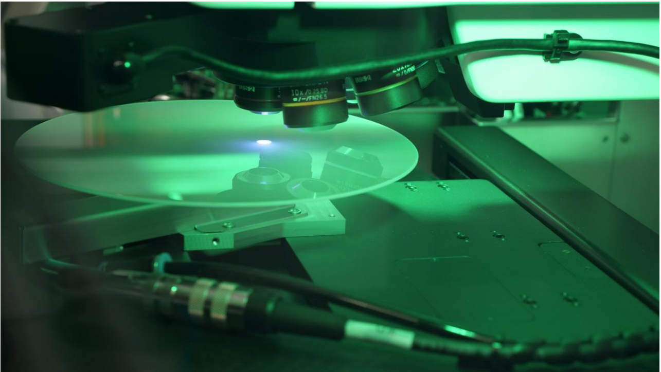
Figura 1. Oblea/plaqueta de zafiro bajo un microscopio de la serie MX. Imagen por cortesía de PVA SPA.
